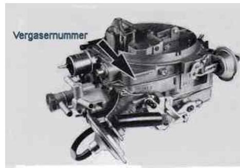
Vergaser: 4A1 Fahrzeuge: DB/ROLLS-ROYCE DB= "001070 73 04" RR= "UE43 439" Anzugsmoment= 8-10Nm
